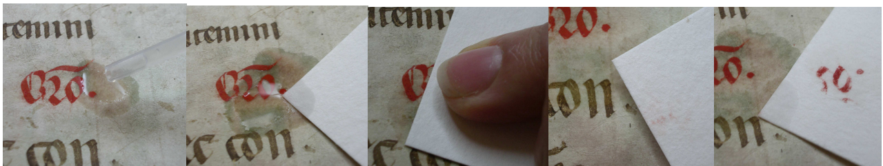
Ilustração 12 – Teste de solubilidade à uma tinta vermelha (feita com cinábrio, pigmento vermelho) onde se verifica que a tinta é ligeiramente solúvel no primeiro teste mas após a repetição conclui-se que é muito solúvel.
